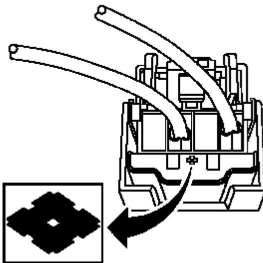
Sumitomo在其连接器上有独特的符号，而且很可能是个零件号。该符号和侧面放置时的金刚石相似，类似于上述图示。该徽标可能出现在任何部位，但通常出现在外壳的线束侧。
